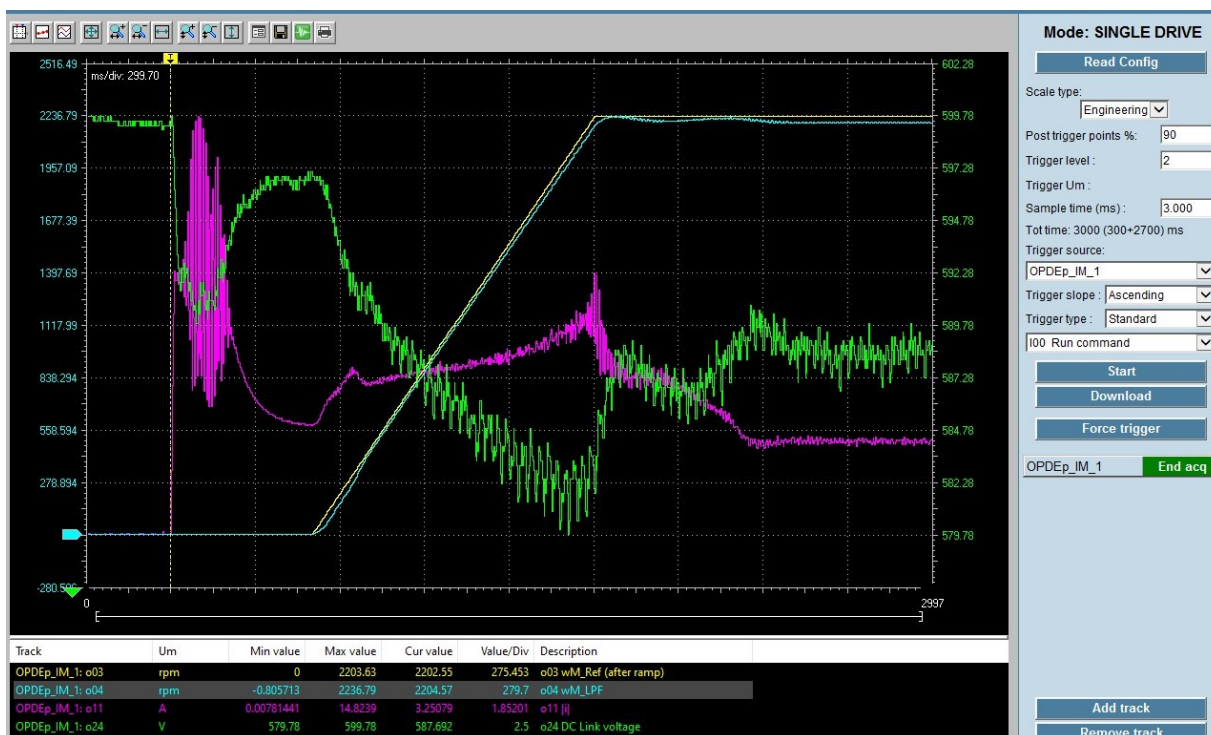
FIG. 6-Esempio di avvio di un motore IM sensorless / IM sensorless motor starting example
